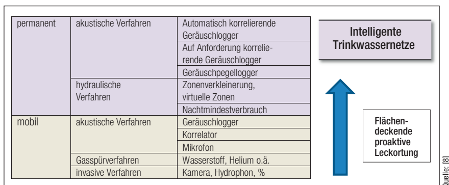
Abb. 2: Zur Leckageortung stehen verschiedene Verfahren zur Verfügung.
