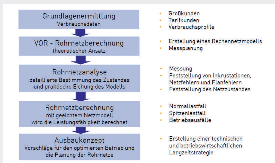
Fig. 8 Vorgehensweise bei einer Rohrnetzanalyse und -berechnung
